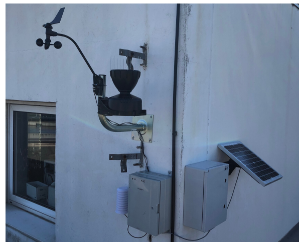
Station météo fixée sur le mur
